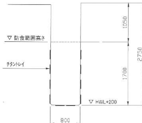
図2 チタントレイ配置断面図
