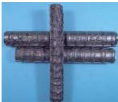
図 - 12 鉄筋除錆処理後
