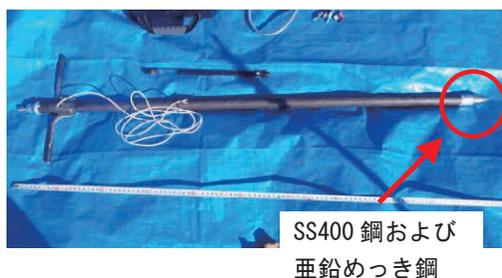
図3 土壤通気性評価用電極の外観
