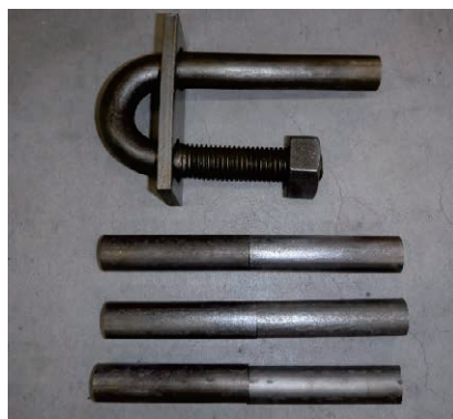
写真3 化学処理後の支線ロッド
