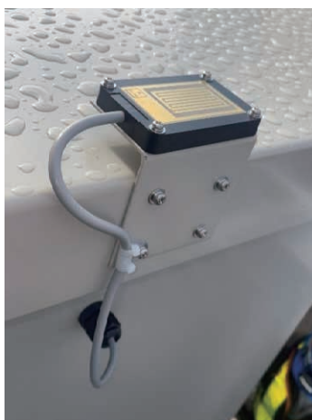
図5 雨センサー屋根設置
